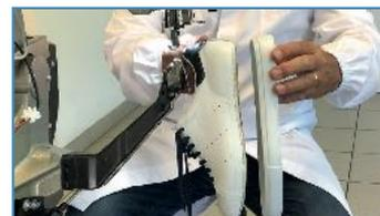
relativo olio e incrementando velocità e precisione; un risultato ottenuto grazie all'aggiunta della movimentazione elettrica del carrello di bloccaggio forma posteriore. La macchina è inoltre caratterizzata da attuatori di ultima generazione più veloci, affidabili, a minor consumo energetico e dotati di funzionalità IoT (Internet of Things) e manutenzione predittiva.
